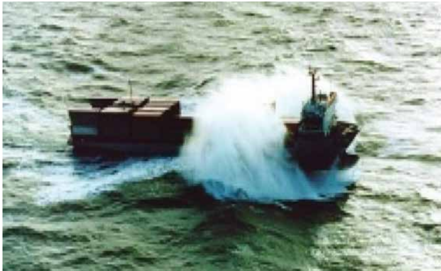
รูปภาพที่ 6 ท้องเรือส่วนหัวกระแทกน้ำ (Pounding)
