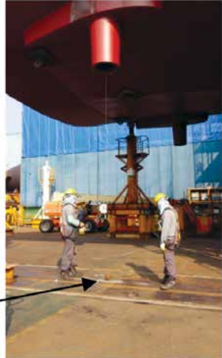
รูปที่ 5 Rudder Ground Marking และ การตรวจสอบตำแหน่งศูนย์กลางกระบอกลงเรือ ขณะทำการประกอบบล็อกท้ายเรือ
